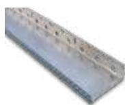
Aluminijasti U-profil za območje „cokla“ z odkapom in ravnim robom za izvedbo spodnjega zaključka fasade. Pritrjevanje z MontageSet. Za optimalno izvedbo in za zmanjšanje možnosti nastanka razpok uporabimo SockelprofilAufsteckleiste.
