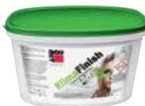
Pastozna naravno bela notranja izravnalna masa za izdelavo gladke površine na apnenih in apneno cementnih ometih, na betonu ter na mavčno kartonskih ploščah. Idealna za ročno nanašanje in primerna za strojno nanašanje.
