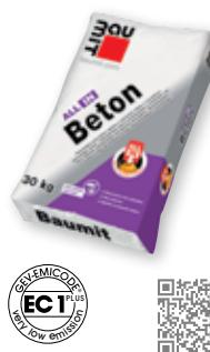
Pripravljeni suhi beton z inovativno tehnologijo samorazgradljive vreče. Ojačan z naravnimi vlakni, razred betona C16/20, za vsa betonerska dela v hiši in na vrtu brez statičnih zahtev, odporen proti zmrzali. Zrnavost 4 mm.
