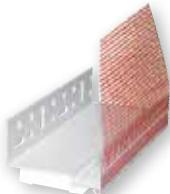
Plastični »cokl« profil za preprečevanje topotnih mostov. Set vsebuje priključni profil z odkapom in s privarjeno mrežico za zmanjšanje možnosti za nastanek razpok. Pritrjevanje z MontageSet. Toplotna prevodnost:  $\lambda = \text{ca. } 0,20 \text{ W/mK}$  (aluminij ca.  $200 \text{ W/mK}$ ). Širina mrežice: 12,5 cm.
