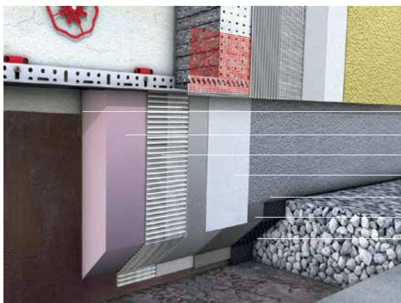
Baumit SupraFixBaumit plošča za podzidek XPS TOPBaumit osnovni omet z Baumit armirno mrežicoBaumit UniPrimerBaumit zaključni slojBaumit FlexProtectzaščitna folija (izvedba med zunanjim ureditvijo)
