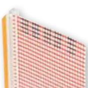
Samolepilna enodelna zaključna letev razreda III s PE tesnilnim trakom, plastično zanko in s privarjeno mrežico za izvedbo tesnega priključka fasade na okenski ali vratni okvir, posebno za nizkoenergijske in pasivne hiše. Zaradi posebnih veznih elementov lahko profil vgradimo brez stikov in z najvišjo stopnjo varnosti. Izvedba s skrito navidezno fugo. Za debeline izolacije do 40 cm pri največji velikosti okna 10 m<sup>2</sup>.
