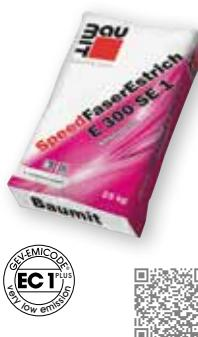
Z vlakni ojačani cementni estrih skupine E 300 (SIST EN 13813 oz. ÖNORM 3732 CT-C30-F5-SE1) za plavajoče, drseče in vezane estrihe, brez dodatkov primeren tudi za talno gretje. Odvisno od vremenskih pogojev, primeren za oblaganje po 24 urah. Primeren tudi za zunanje površine.
