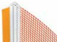
Samolepilna dvodimenzionalna gibljiva zaključna letev razreda II s teleskopskim raztezanjem, s privarjeno mrežico in s tesnilnim trakom. Za izvedbo tesnega priključka fasade na okenski ali vratni okvir. Možnost montaže tudi po lepljenju izolacije oziroma po nanosu osnovnega ometa. Za debeline izolacije do 30 cm pri največji velikosti okna 10 m<sup>2</sup>.
