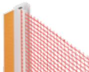
Samolepilna zaključna letev z zračno komoro, s privarjeno mrežico in s tesnilnim trakom. Za izvedbo tesnega priključka fasade na okenski ali vratni okvir. Za debeline izolacije do 30 cm pri največji velikosti okna 10 m<sup>2</sup>.
