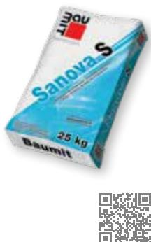
Sanacijski omet za ročno in strojno nanašanje, vodooodbojen, za notranje in zunanje površine ter zmerno vlažne zidove, predvsem v področjih večjih mehanskih obremenitev pod vplivom vode („cokla“) pri novogradnjah in sanacijah. Znavost 2 mm.
