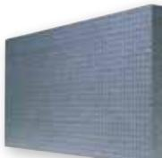
Sive paroprepustne fasadne izolacijske plošče na osnovi EPS (ekspandiranega polistirena) po SIST EN 13163 ( $\mu \leq 10$ ), z izboljšanimi toplotnoizolacijskimi lastnostmi, kot sestavni del fasadnega sistema Baumit open. Posebej primerna za toplotne prenove fasad.
