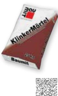
Malta z vsebnostjo trasa, skupina malt M10, za višje statične obremenitve. Posebno za izvedbo vidnih pozidav. Zrnavost 2 mm.
