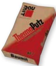
Topotnoizolacijski perlitni omet za ročno nanašanje na mineralne, obrizgane podlage, za zunaj in znotraj. Lahek in izdaten, zrnavost 2 mm. Topotna prevodnost:  $\lambda = 0,12 \text{ W/mK}$ .
