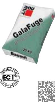
Izboljšana dobro zalinva malta za fugiranje kamnitih tlakov pri fugah širine nad 5 mm. Odporna proti zmrzali in soli. Zrnovost 2 mm. Ni primerna za fugiranje robnikov.
