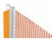
Samolepilna zaključna letev razreda III s tesnilnim trakom in s privarjeno mrežico za izvedbo tesnega bočnega priključka na predhodno vgrajena roletna vodila. Za debeline izolacije do 30 cm pri največji velikosti okna 10 m<sup>2</sup>.
