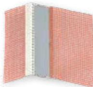
Dilatacijski profil s privarjeno mrežico za izvedbo tesnih fasadnih dilatacijskih fug na ravnih površinah in pri notranjih vogalih. Širina fuge od 5 do 25 mm.
